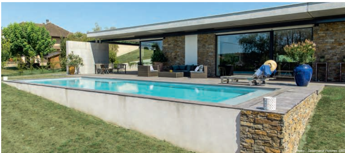
Bassin rectangulaire avec structure Keps, permettant de réaliser un mur en béton armé de 16 cm d'épaisseur ininterrompu et une double isolation.
